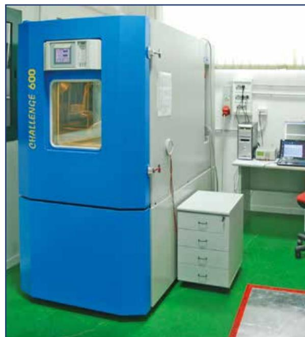
Le sale prova lavorano a tempo pieno durante la progettazione. Nella foto la camera climatica, in grado di riprodurre qualunque condizione climatica sia in temperatura, sia in umidità.
