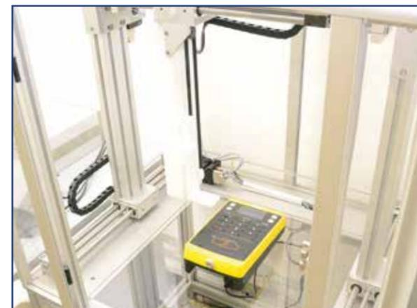
Tra i test, una parte rilevante circa la conformità normativa della sezione contactless, attuabile solo in un laboratorio molto attrezzato. AEP è probabilmente l'unica azienda italiana che dispone di un sistema robotizzato per la misura del campo nello spazio.
