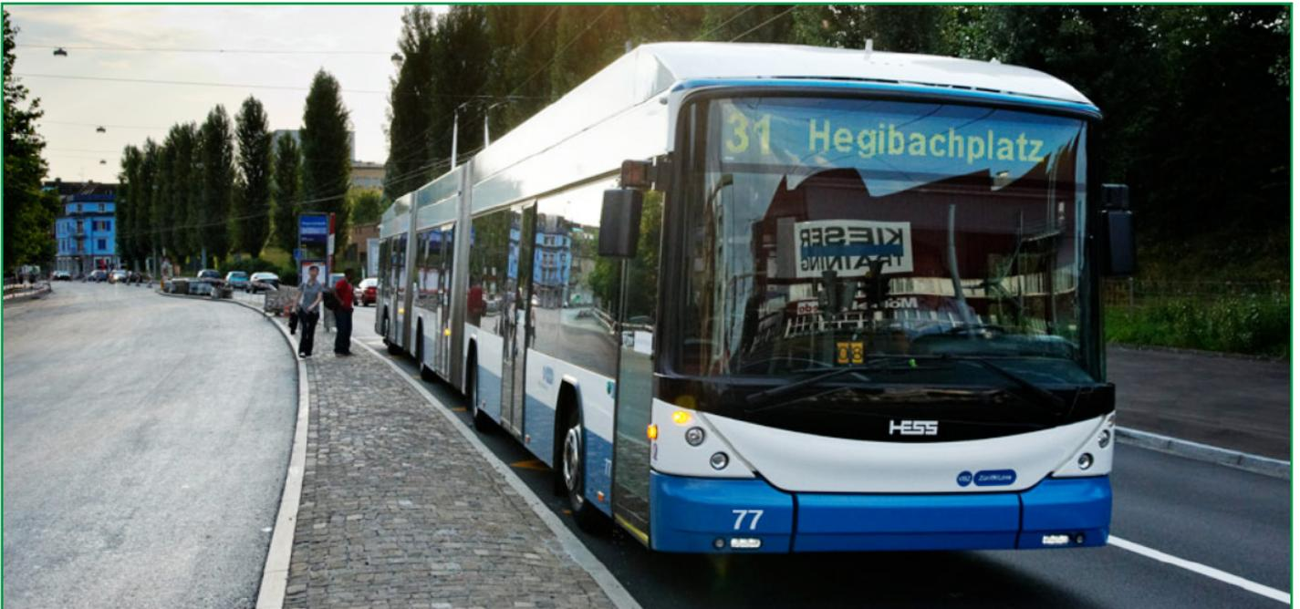
Fonte [www.hess-ag.ch](http://www.hess-ag.ch) - La rete filobus di Zurigo, che conta 6 linee (31-34, 46 e 72) ed è estesa per 54 km, utilizza 78 veicoli di cui 61 filosnodati di 18 m e 17 filobisnodati di 24 m, detti Hess Light Tram e prodotti dalla Hess-AG.
